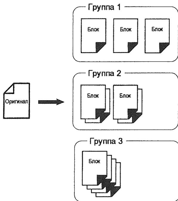
Если в АПО загружено несколько листов оригиналов (до 10), то при дополнительно включенном режиме автоматической печати тиражирование идет для каждого листа до полного окончания печати оригиналов и сортировки оттисков в группы так, как это задано программными установками.
